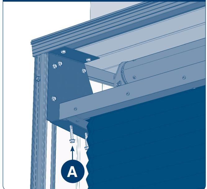
Рис. 4.4.7. Установите шпильки
