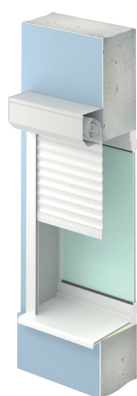
Накладной монтаж, короб наружу
